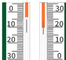
付属の磁石を使用し、指示棒が完全に赤液の中に入るまでなで上げます。（指示棒が透明液に入った場合、付属の磁石でなでると指示棒がついてきます。）
