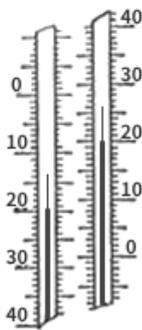
使用前には左図のように虫を磁石で水銀柱につけてください。
