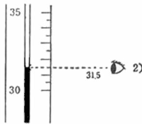
温度を正しく読取る場合は左図のようにして直角の方向から見るようにしてください。
