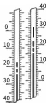
U字型最高最低温度計は水銀柱が太いため輸送や運搬中に震動で水銀が切れたり、気泡が入る事があります。そんな場合は下記の方法で直してください。
