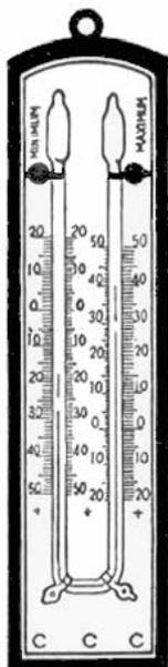
左図のようにガラスをU字型にして毛細ガラス管の曲がった所に水銀を置き、又左側の球部にアルコールをおき、そのアルコール受部の膨張、収縮によって、水銀を介して左右の毛細管中の虫（示標とも言う）を動かし、1本の温度計で最高温度と最低温度、それに現在温度も読み取る事の出来る大変便利で簡単な温度計です。
